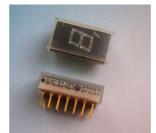
Нумерация выводов показана условно «Точка» на корпусе обозначает начало отсчета выводов
